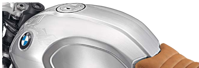
10 Aluminium-Tank mit verschliffener Schweissnaht
