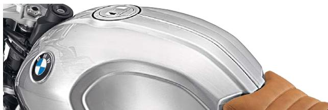
10 Réservoir en aluminium avec soudure rectifiée à la meule
